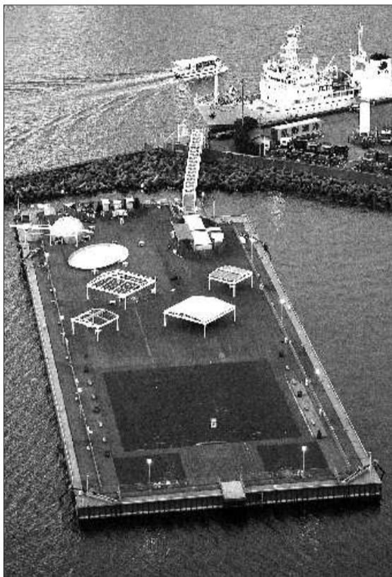
2011年4月1日,日本静冈港口的大型钢制浮体。这个大型钢制浮体将被用来存放福岛第一核电站厂区内的高辐射积水。
