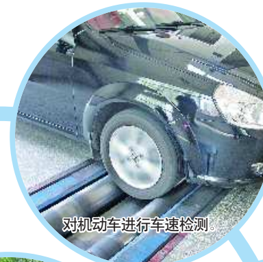
对机动车进行车速检测。
