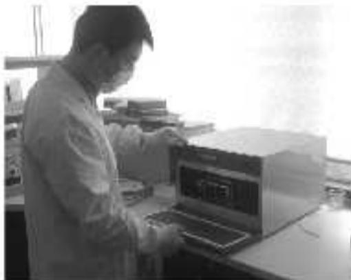
采集的样品在进行相关处理后,放到一个由八个试管组成的试剂板上,再放入这台核酸提取仪内,DNA会自动被提取出来。
