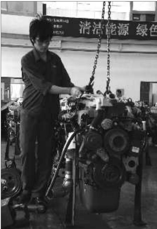
在潍柴动力西港新能源发动机有限公司里,工人正在装配大型车辆专用的LNG发动机。
