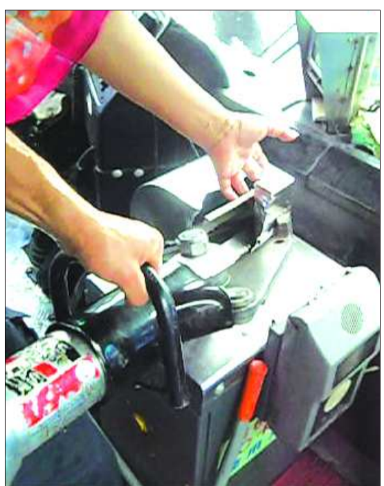
消防人员正在用液压剪破拆投币箱。(消防供图)
