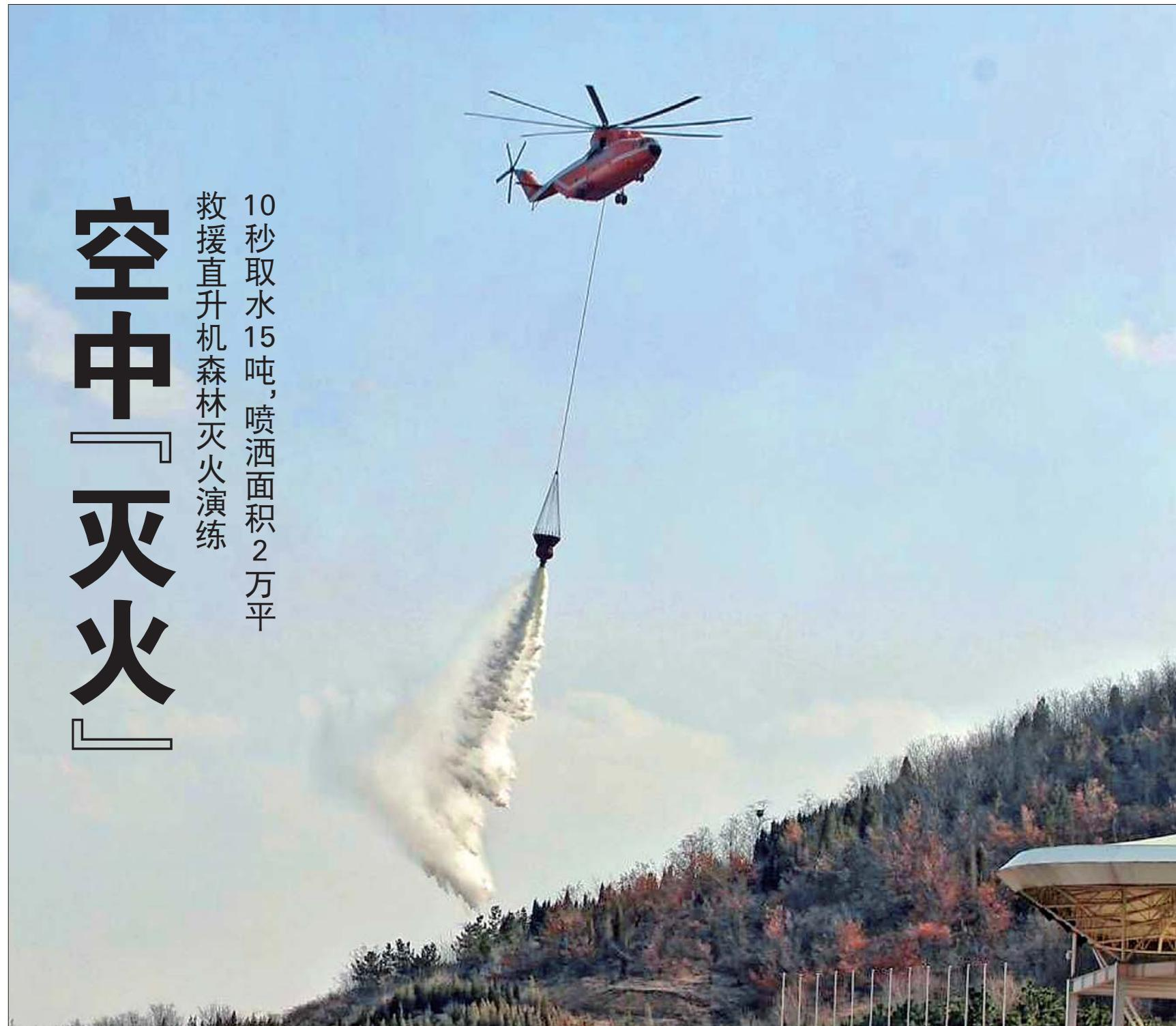
3月10日，山东省航空应急救援莱芜基地进行救援直升机编队联训并开展灭火演练，四架救援直升机参加演练，包括目前世界上在役最大的直升机米-26。据山东省航空护林站站长任方喜介绍，该机型能在10秒钟左右灌装最多15吨救援用水，在最大装水量的情况下可喷洒出长300米、宽60至80米的水带，喷洒面积2万平方米，达到快速灭火的效果。
