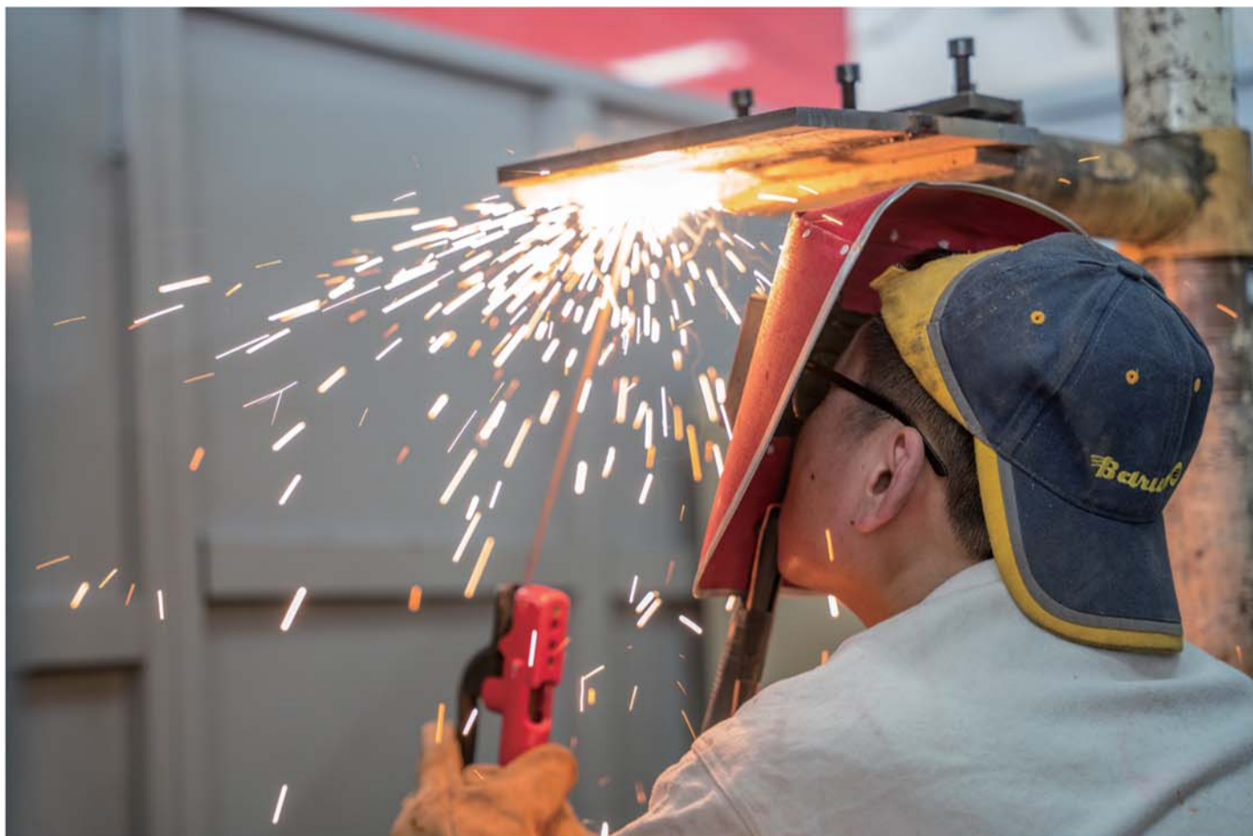
▶选手在“飞火流星”中展示仰焊技艺。
