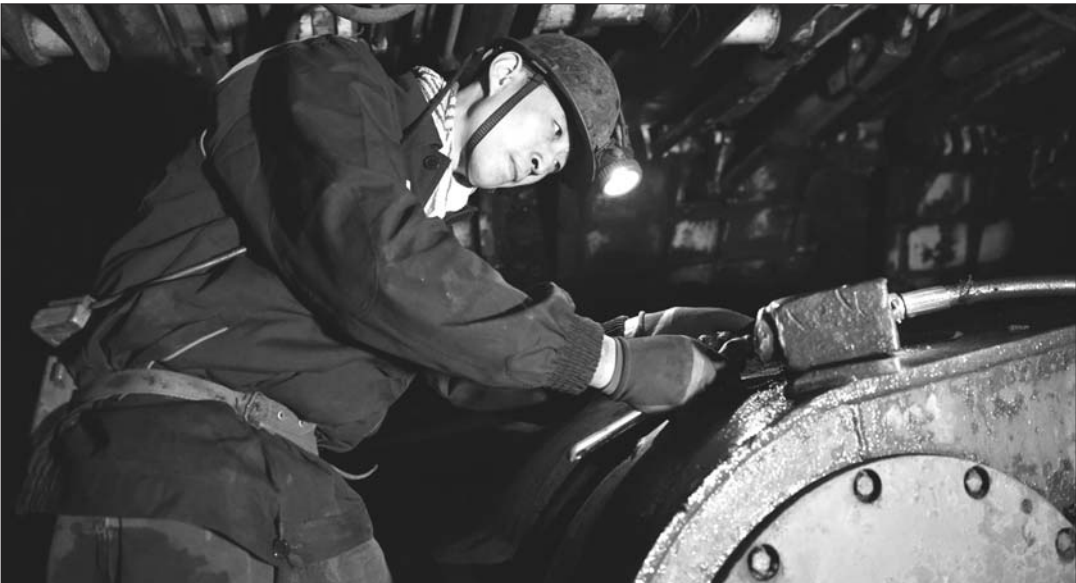
陈兆旭正在井下维修采煤机。
