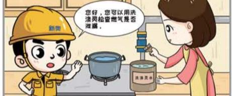
用户应该定期进行安全自检，可用洗涤灵水涂抹在燃气表、燃气管道、阀门等各连接处检查是否漏气，如有气泡证明有漏气现象，需及时报修。
