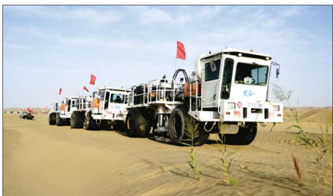
顺北8井区项目全部采用可控震源高效采集激发,既安全环保,又为替代炸药激发积累了宝贵经验。通讯员 蒋云龙 摄
