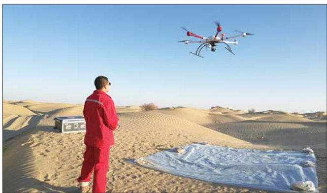
SGC2109队采用无人机航测,详细掌握工区沙丘密度、高度和道路状况。通讯员 马世军 摄
