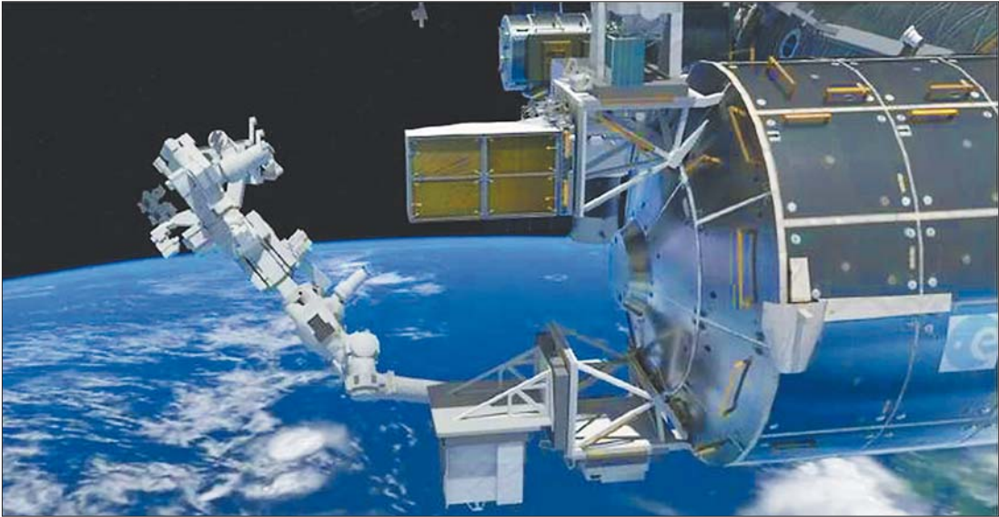
安装在国际空间站外部的空间碎片传感器,可收集太空垃圾的信息。
