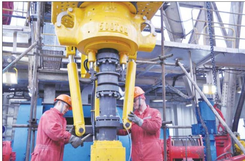
近日,胜利石油工程公司海洋钻井公司胜利十号平台更换顶驱调试完成,这是胜利海上平台首次自主更换顶驱。据了解,老旧的顶驱是钻井平台提速提效的短板,更换顶驱通常在坞修时完成。为全面提速提效,该平台主动请缨自主更换顶驱,并与装备、安全部门对接拿出了可行性方案,设备维修小组将工作细化成12个大项目、23个小项目,利用配合海洋采油厂安装生产模块时机,顺利组织了顶驱更换工作。
