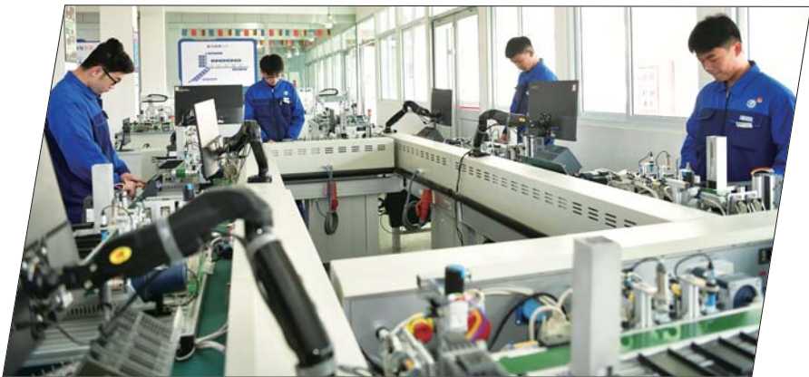
平度市技师学院学生进行中德机电一体化设备实习操作，完全按照企业产线设计，可以完成物料的出库、自动分拣、入库等操作。
