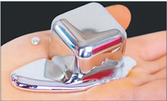
液态金属质量更轻,强度却更硬,是不锈钢的3倍,铝、镁合金的10倍以上。
