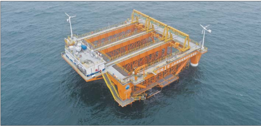
长岛南隍城岛海域的“国鲍1号”,是全国首个以鲍鱼为主题的深远海坐底式海珍品智能网箱,可悬挂3万多个鲍鱼养殖箱笼,年产可达120吨。
