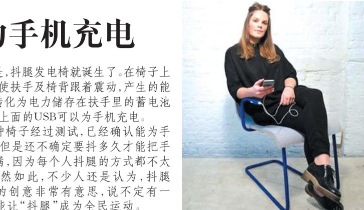
于是,抖腿发电椅就诞生了。在椅子上抖动,会使扶手及椅背跟着震动,产生的能量就能转化为电力储存在扶手里的蓄电池中,通过上面的USB可以为手机充电。
