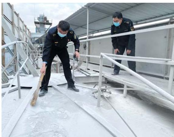
▲在水泥建材厂30米高的粉状物料仓顶部检查呼吸口粉尘排放问题。
