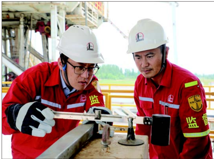
现场监督人员在认真抽查钻井液密度,确保安全优快钻井施工。
