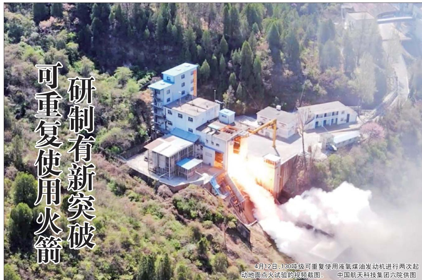
4月12日,130吨级可重复使用液氧煤油发动机进行两次起动地面点火试验的视频截图。中国航天科技集团六院供图
