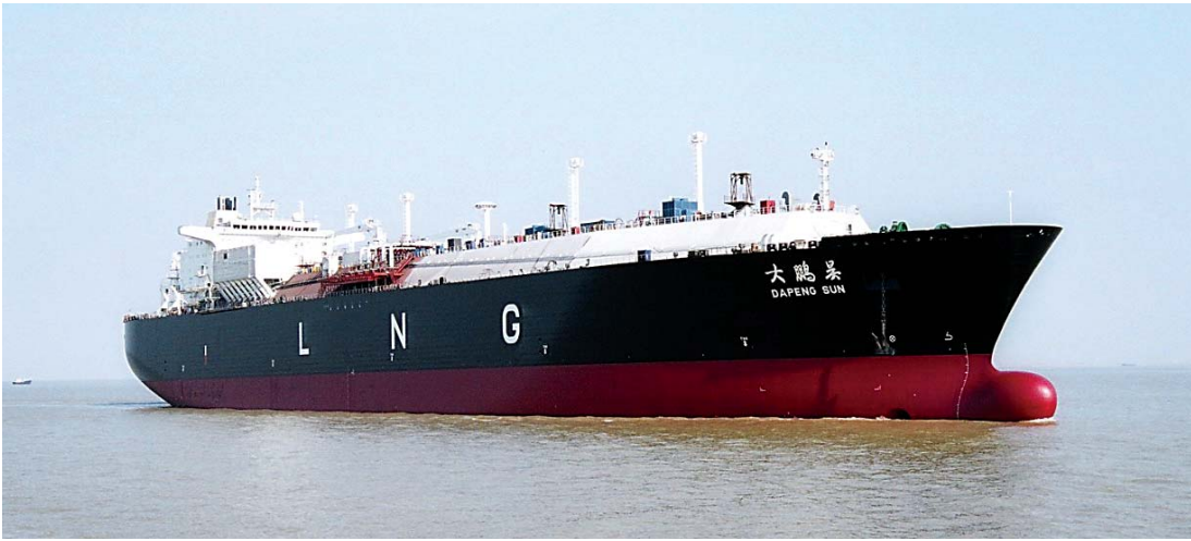
沪东中华建造的14.7万立方米LNG运输船“大鹏昊”。(沪东中华造船(集团)有限公司网站)
