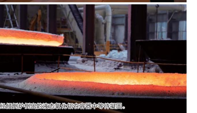
经倾倒炉倒出的液态氧化铝在容器中等待凝固。
