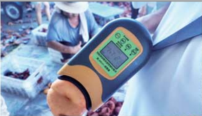
电商使用无损测糖仪检测甜度。
