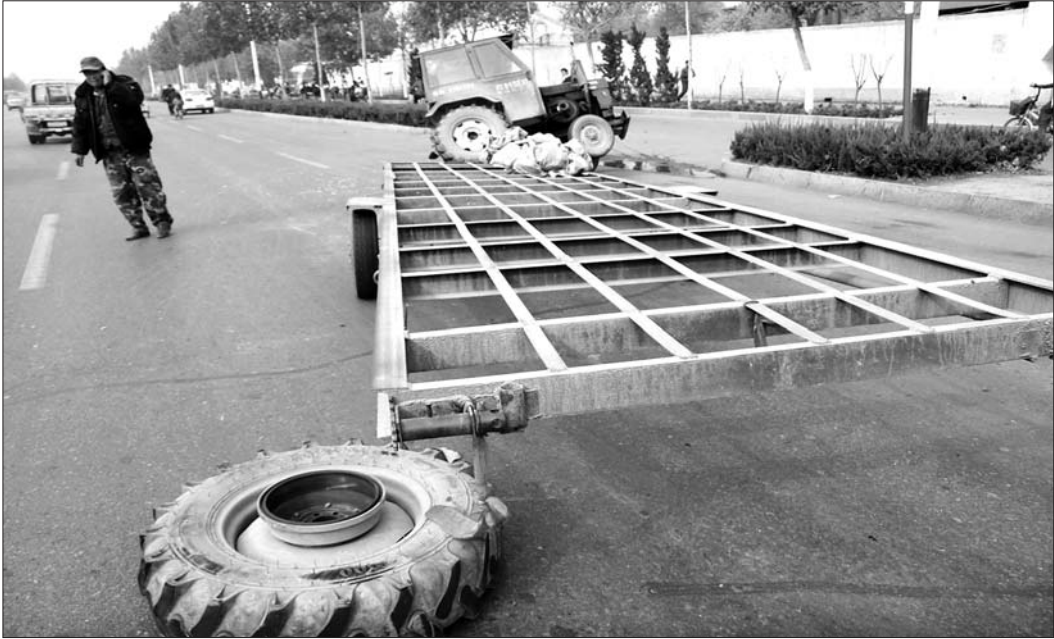
15日,在德州市大学西路与解放北大道交叉口往西50米处,一辆加长拖拉机在行驶途中左侧动力轮因螺丝松飞出车外,拖拉机顷刻间失去重心,滑出五六米远。司机左腿受伤但没有大碍。 本报记者 王金强 摄
