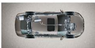
AAC全独立主动响应式底盘悬挂系统
