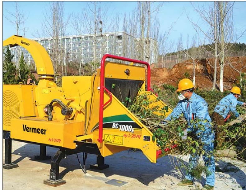
两名工作人员正在粉碎枝条等园林绿化废弃物。 王光营 摄
