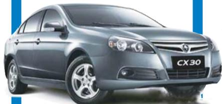
长安CX30有1.6L六款、2.0L三款,搭载五速手动变速箱和四速自动变速箱。作为志翔的两厢版,CX30的动力配置和主要装备与志翔类似,但其外观设计更具时尚动感,前格栅采用了镀铬单横格栅设计,同时加入高亮度熏黑运动大灯,集成转向灯的后视镜、动感C柱尾灯、车顶行李架等时尚设计元素。
