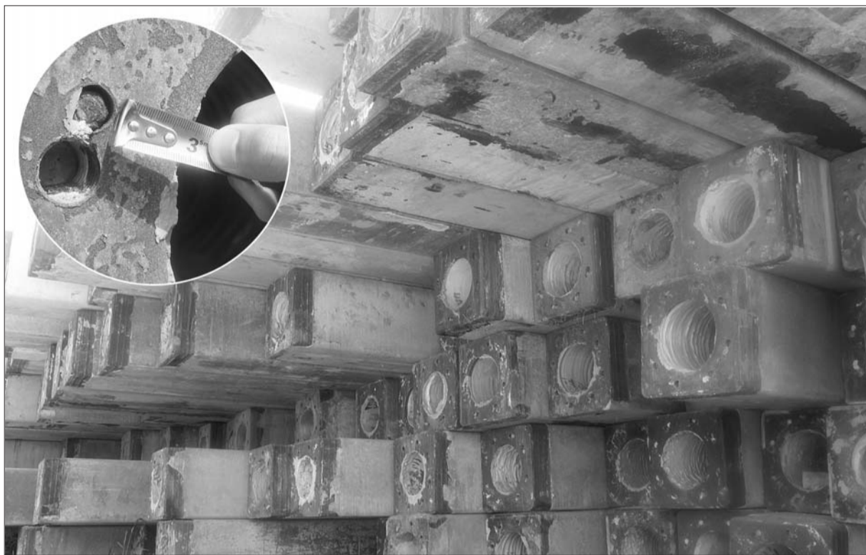
在菏泽巨野,堆放在菏泽中技桩业厂房处的圆形配筋空心方桩,内保护层在2.5厘米左右。记者 梁斌 摄
