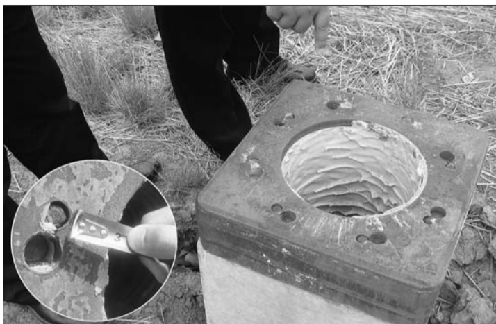
在天津空港经济开发区一建设项目现场,被打进地下后作废的圆形空心方桩。
