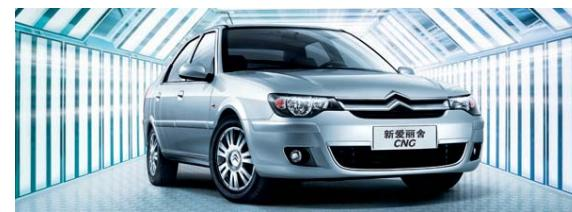
新爱丽舍CNG双燃料车采用原厂统一设计制造,全部安装了意大利进口的天然气系统,燃料供给系统和动力系统的匹配经过了严格的计算,能实现天然气的稳定燃烧。新爱丽舍CNG双燃料车整车在法国PSA集团曾进行爆破和火烧试验。经过测试,不仅通过欧洲的使用标准,更完全符合中国使用标准。
