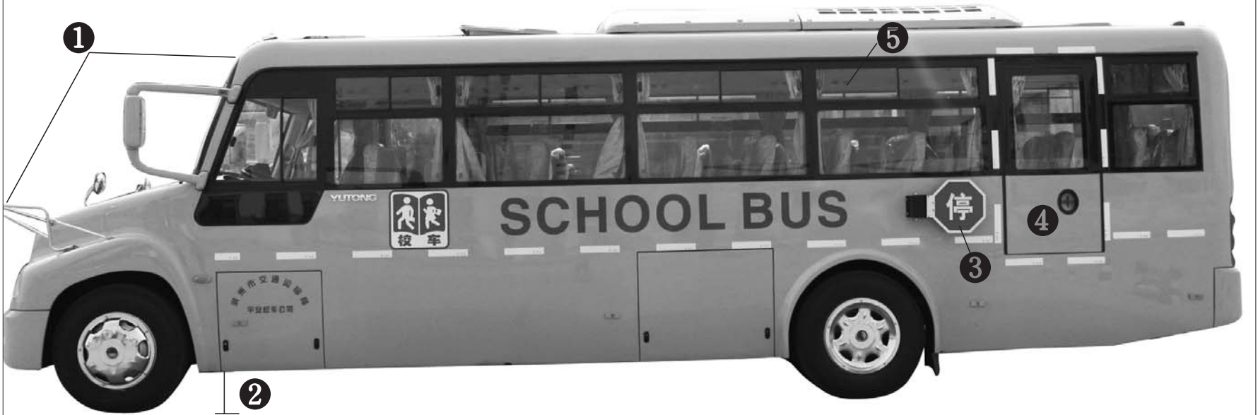
①新校车长头设计可有效缓冲撞击。 ②内地板离地高>1米。 ③车身警示牌,上面涂有红色的“停”字。 ④位于中后部的安全门便于从车后部逃生。 ⑤车窗采用下封闭、上推拉式设计。
