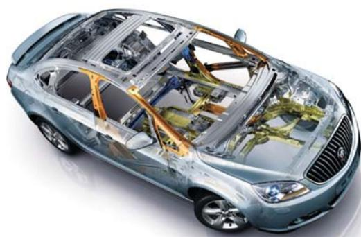
故,英朗GT在前后防撞钢梁上进行了专项加强,前后防撞梁均采用高强度铝合金制造,可以在车辆被碰撞时起到缓冲、吸能作用,给乘客更多的被动安全保障。在车内,每一位英朗GT的乘员都能享受到专属的360度立体柔性保护:4安全气囊充分保护车内成员安全,并防止车外物体刺入车内;人体工程学运动座椅在
