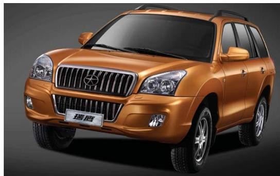
瑞鹰1.9CTI柴油版升功率达到了52.4KW/L,排量为1.947L,额定功率达96.5KW,最大扭矩可达235N·m,而10万级SUV普遍采用自然吸气的发动机,多数是汽油发动机,没有涡轮增压。在最大功率方面,10万级SUV几乎都
