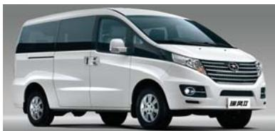
瑞鹰1.9CTI柴油版堪称“都市低碳精英”,一方面目前柴油发动机普遍优于汽油发动机,柴油机普遍比汽油机省油30%。而且柴油发动机的劲更大。另一方面1.9CTI发动机实现强大动力与燃油经济性的完美结合。该发动机运用了国际领先技术VNT(可变喷嘴)增压与第三代高压共轨直喷技术,两者配合实现了动力性能的完美提升,升功率达到了52.4KW/L,排量为1.947L,额定功率达96.5KW,最大扭矩可达235Nm,强劲的动力输出使得瑞鹰1.9CTI柴油版优异的动态性能得以突显。同时,融入了例如可控涡轮比(SCV)技术
