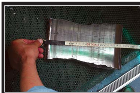
▲造成吴斌死亡的制动毂脱落残片照片
