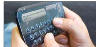
近日,一家名为Tactus的公司开发了一种新的触摸屏技术,该技术所生成的动态键盘将支持任何类型的按键,其工作方式:经由发出的指令从触摸屏中凸出按键,当使用完毕后,这块凸出显示屏的键盘就会自动回落,与整个显示屏无缝结合。用户通过触摸屏幕建立一个拥有物理按钮的全键盘。
