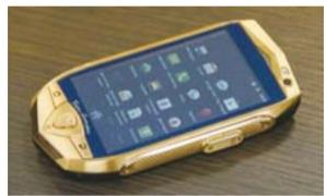
兰博基尼此次发布的另一块手机为Android智能手机,型号为TL700,这款手机采用高通芯片,屏幕为3.7英寸的WVGA分辨率,并采用500万+30万像素(前置)的摄像头搭配。TL700具备4GB的内置存储空间,电池容量为1400mAh。其奢华的镀金机身、深蓝宝石镀膜层屏幕以及鳄鱼皮后盖让它显得与众不同。
