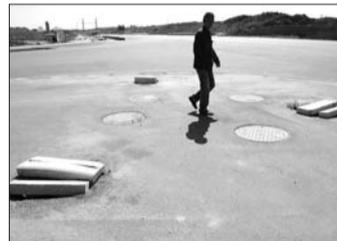
在一路口,3个铁井盖丢失,复合材料的没丢。
