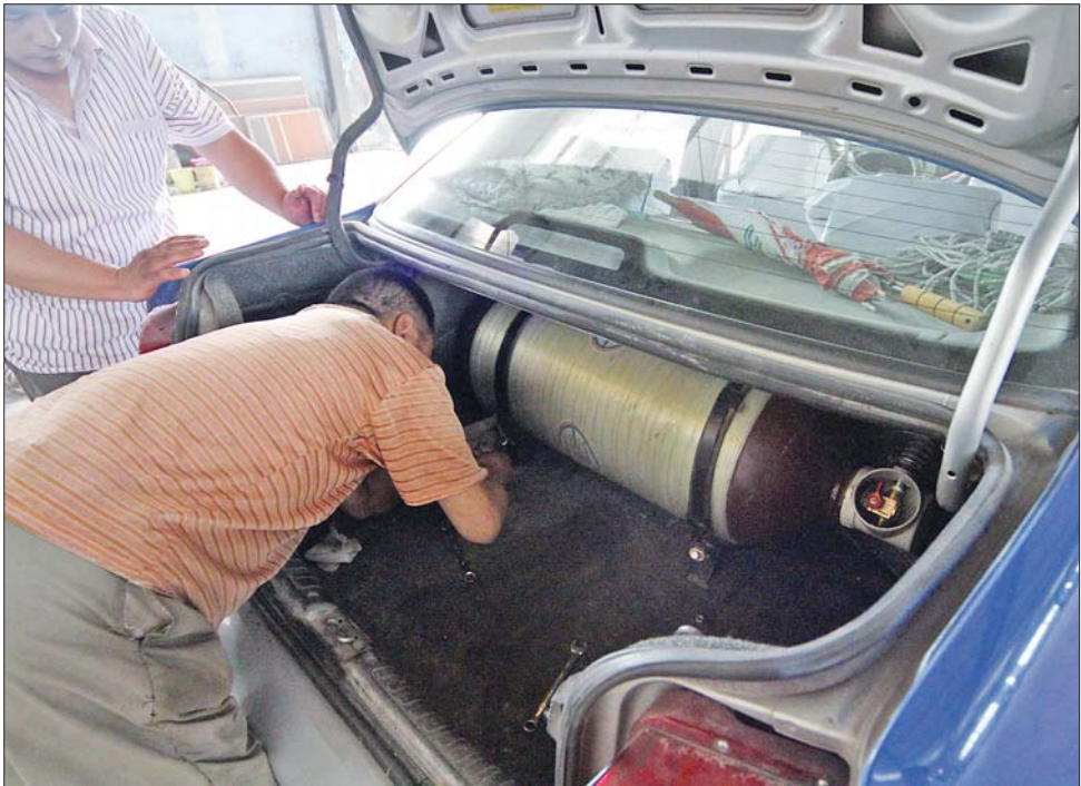
▲一辆出租车正在更换燃气瓶的气阀。 本报记者 王鸿光 摄
