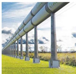
美国设计师近日开发了一种超高速火车方案,据称这种超快速火车可以在1小时内将旅客从纽约送至伦敦,其时速可以达到惊人的4000英里(约合6400公里)。这种火车的计是一种圆筒状列车,在一根气密管道内运行。当抽出列车前方的所有空气,那么列车后方的气压差就会推动列车在管道内高速行进。
