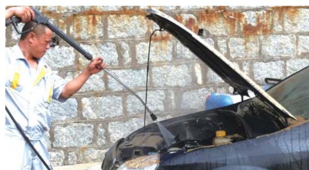
告诉记者,现在正在进行清理工作。他称,被水淹了的车,首先要用水进行清理,然后将车拆解,检测哪些部件已经损坏。
