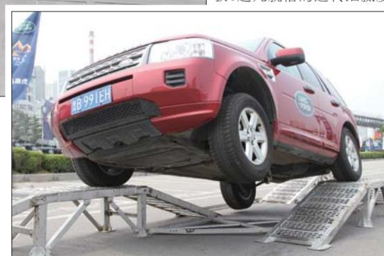
大越野能力的还有其优异的接近角、离去角、障碍跨高度表现，任道路崎岖起伏，只作一马平川。最新一代陡坡缓降控制系统(HDC)可以在松开脚刹后轻松接管制动系
