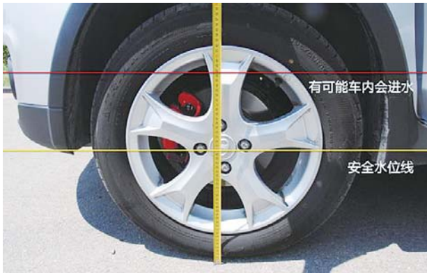
安全水位线以及可能会导致车内进水的水位线
