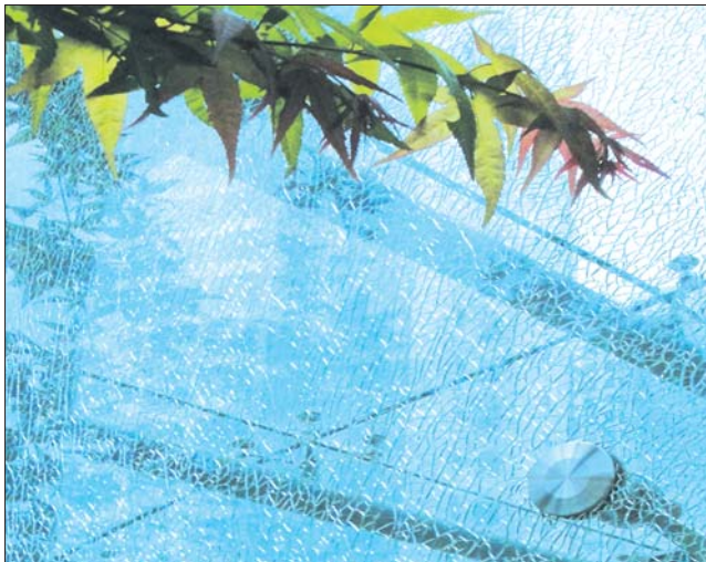
好好的钢化玻璃成了“蛛网”玻璃。 见习记者 蒋慧晨 摄
