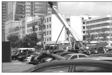
被吊车塔臂砸倒的电线杆,将附近轿车砸坏。
