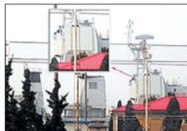
052D型驱逐舰采用了新型散热系统,没有原先的户型雷达罩,采用了轻便的平板雷达罩。到目前为止,现役的舰用较大有源相控阵多功能雷达外壳都采用了圆弧形设计,只有美国还未服役的AN/SPY-3雷达采用了平板外壳,这标志着中国有源相控阵雷达技术水平有了非常巨大的提升。
