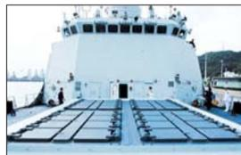
052D型驱逐舰的垂直发射系统,由052C的左轮式圆形发射筒,改为了方形发射筒,兼容冷弹射垂发和热发射垂发系统,可以采用冷弹射来发射大型反舰导弹,使用热发射来发射巡航导弹等,有最好的兼容性。除了首部的32枚导弹外,直升机库前方还布置有该型发射装置。052D型驱逐舰可能会配备海军版的“东海”-10对地攻击巡航导弹。
