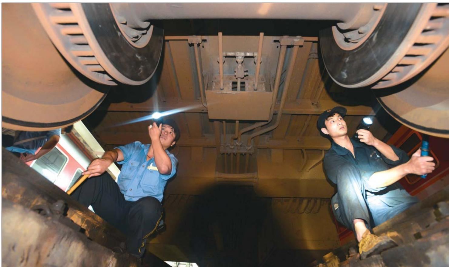
▲检测车辆的制动装置时，两名工人蹲在车辆两侧“擦、望、敲、听”。
