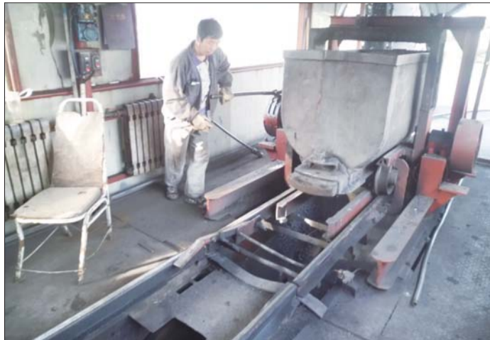
工人正在将矿车里的煤转移到传送带上。
