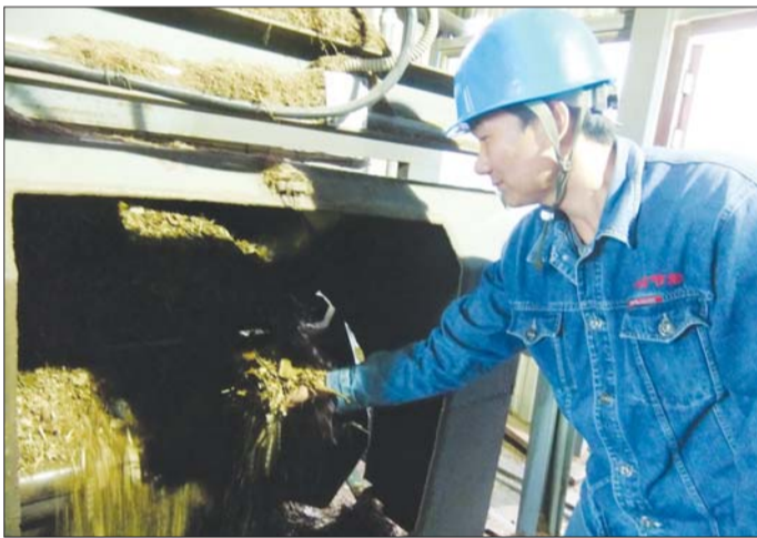
苹果枝条粉碎后,通过传输带送到锅炉燃烧。记者 秦雪丽 摄
