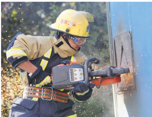
消防官兵正在利用无齿锯破拆钢板
