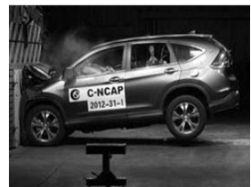
前挡风玻璃出现裂痕,副驾驶员假人发生轻微位移。
