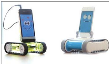
它的硬件设备看起来像一部迷你小车,当你把安装了Romo应用的iPhone安置上去,你可以通过其他苹果设备进行控制,此刻iPhone与运载它的小车变身机器人,可以到处行走,iPhone界面上会出现可爱的Romo表情。通过控制,你可以用它实现几乎所有个人机器人的基本功能。
