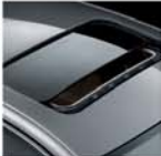
防夹双开启模式电动天窗, 可分段开启
